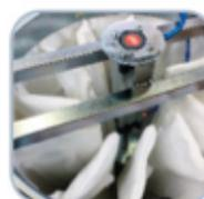
Die Option PSC bietet die Möglichkeit an mittels Knopfdruck einen Rüttelmechanismus zur Filterreinigung auszulösen. Alternativ kann über eine SPS eine vollständige automatische Rüttelabreinigung erfolgen.
