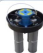
SP ist das beste automatische Filterpatronenreinigungssystem das Druckluft (6 bar) benutzt. Die große Filterfläche und hohe Effizienz erlauben mit große Menge feiner Pulvern zu arbeiten. Die Filter sind Aluminate und Antistatische mit BIA-M (EN 60335-2-69) Klassifikation. Die Filterreinigung erfolgt bei laufendem Gerät.
