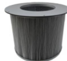
Die Abscheidung erfolgt über eine BIA- Klasse M Filterpatrone mit einem Abscheidegrad von 99,9%. Eine hohe Filterfläche sorgt für lange Standzeiten. Das bedeutet, dass alle Partikel bis zu einer Korngröße von 1µ abgeschieden werden. Motoren und Bediener werden somit vor Schmutzbelastungen geschützt.
