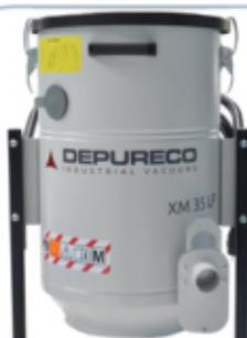
Der XM35 ist mit dem Jetclean- Abreinigungssystem ausgestattet. Über eine manuell zu öffnende Klappe strömt während des Betriebs Luft in die Kammer des Saugers. Durch den entstehenden Sog verwirbelt die Luft im Gehäuse und reinigt das Filterelement ab. Ein optionaler manueller Absperrschieber verriegelt die Zuluft des Ansaugstutzen und erhöht die Effizienz der Abreinigung. Nach der Entriegelung des Absperrschiebers kann die Absaugung fortgeführt werden.
