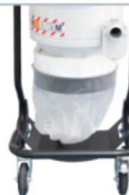
Das Material wird in einem stabilen Plastikbeutel namens Longopac® gesammelt. Er hat eine Speicherkapazität von bis zu 20 m und wird im unteren Teil der Filterkammer aufgerollt. Wenn der Sauger abgeschaltet wird, fällt das Material automatisch in den Beutel hinein. Nach dem Befüllen des Beutels kann der Bediener ihn verschließen, schneiden und den Staub kontaminationsfrei aufbewahren. Daraufhin kann der neue Beutel vorbereitet werden
