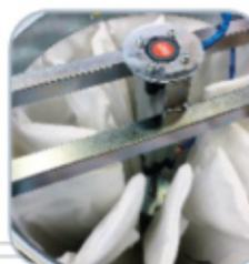
Die Option PSC bietet die Möglichkeit an mittels Knopfdruck einen Rüttelmechanismus zur Filterreinigung auszulösen. Alternativ kann über eine SPS eine vollständige automatische Rüttelabreinigung erfolgen.
